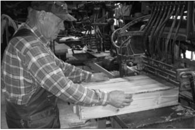
Vid den tredje spikmaskinen sätter Olof Johansson fast lådans botten.
