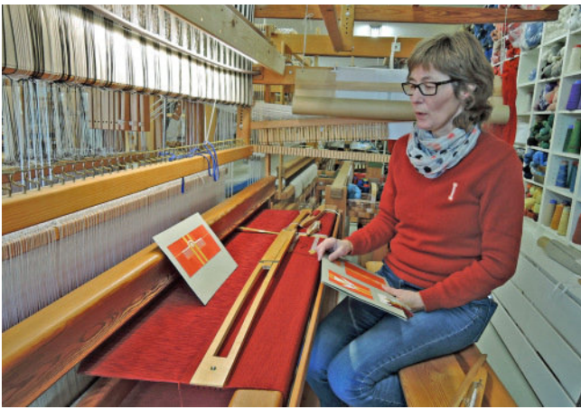
Helena vid vävstolen som tillverkats i Öxabäck. Den är ritad av Ulla Cyrus och just denna är utrustad med mer än 40 skaft och har dragutrustning.
