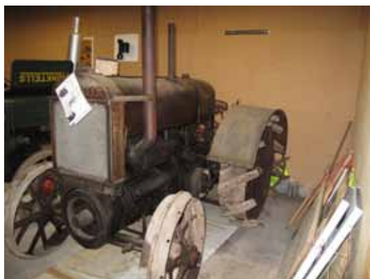
Munktell typ 22 tillverkad 1929. Den här traktorn är försedd med järnhjul. Traktorn går fortfarande att köra. Den finns på Särestads Lantbruksmuseum.
