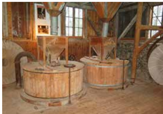
Kvarnens två bevarade stenkar med stenpar och kvarntratt. Foto: VGR.
