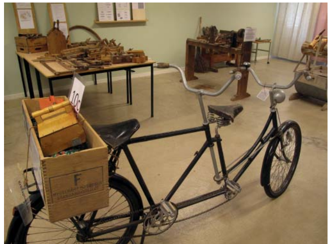
Amerikansk tandem. På en svensk tandem sitter herrn främst och damen bakom. På den här tandemmen är det tvärt om, damen sitter främst. På en svensk tandem är det bara det främre styret som går att använda, på den här cykeln kan båda styra, bara de är sams.
